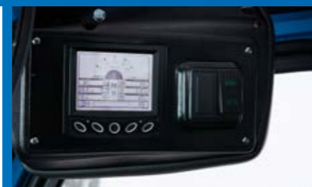
Multifunktionales LCD-Display inkl. Betriebsstundenanzeige, Tank-, Kühlwasser und Temperaturanzeige
