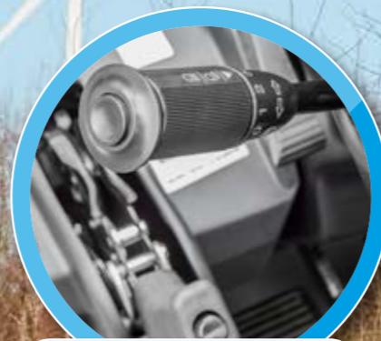
Fahrrichtungsschalter mit 3 Vorwärtsgängen – Stapler erreicht Höchstgeschwindigkeit von bis zu 26 km/h
