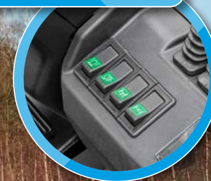
Umschaltung 2-Rad-/4-Rad-Antrieb für höhere Laufgeschwindigkeit und stärkere Steigfähigkeit. Manuelle Differential-Sperre speziell für unwegsames Gelände, bietet ultimative Traktion und verhindert Kraftverlust bei durchdrehenden Rädern.
