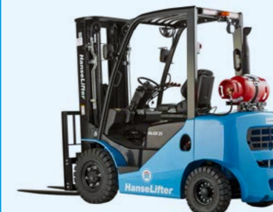
Treibgasstapler mit 1,5 bis 7,0t Tragfähigkeit
