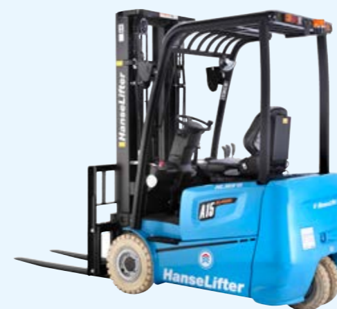
3-Rad-Elektrostapler mit 1,3 bis 2,0t Tragfähigkeit
