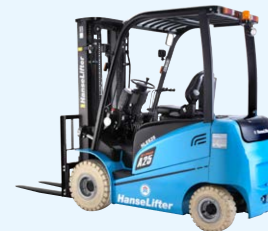
4-Rad-Elektrostapler mit 1,5 bis 16t Tragfähigkeit
