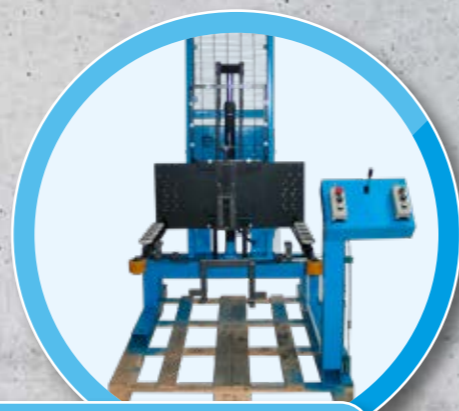
Elektrohochhubwagen mit elektronischer Bedienstation und kundenspezifischer Aufnahme
